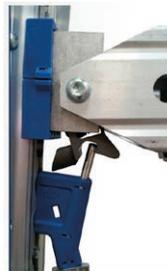
Для направляющих, устанавливаемых на поверхность грузового отсека.
