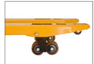
Двухосные передние колёса и вспомогательные колёса сзади облегчают захват поддонов с грузом и ускоряют обработку груза.
