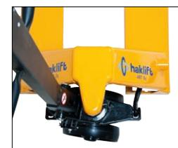
Угол поворота 210° обеспечивает лёгкое и быстрое вращение тележки, гидравлическая система не требует обслуживания, что облегчает эксплуатацию.
