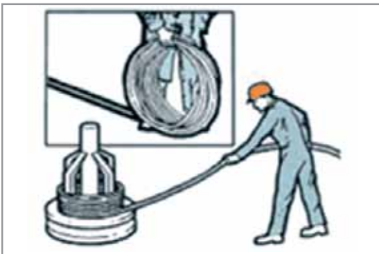
ПРАВИЛЬНЫЙ СПОСОБ размотки каната
